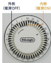
ONにしたい時間帯はピンを内側に、OFFにするにはピンを外側に移動させるだけの簡単設定
